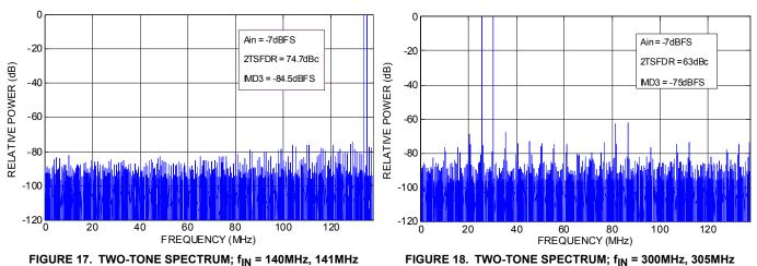
FIGURE 17. TWO-TONE SPECTRUM; f<sub>IN</sub> = 140MHz, 141MHz
