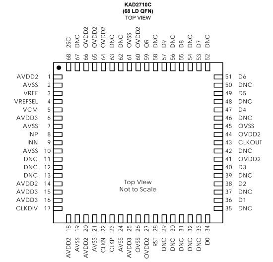
FIGURE 2. PIN CONFIGURATION
