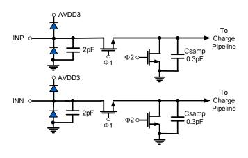
**FIGURE 28. ANALOG INPUTS**
