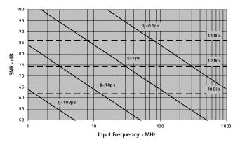
FIGURE 27. SNR vs CLOCK JITTER
