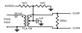
FIGURE 26. RECOMMENDED CLOCK DRIVE
