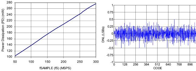
FIGURE 9. POWER DISSIPATION vs f<sub>SAMPLE</sub>
