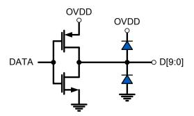
FIGURE 30. LVCMOS OUTPUTS
