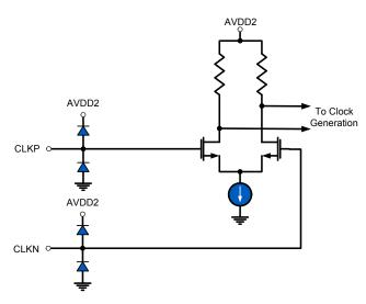
FIGURE 29. CLOCK INPUTS
