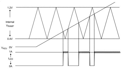
Figure 1. PWM Soft-Start Behavior Mechanism
